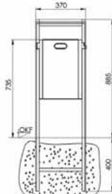
Frontansicht zum Einbetonieren
