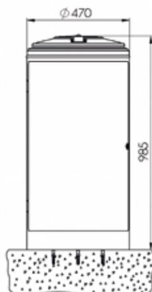
Montage auf Betonfundament
