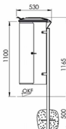
Seitenansicht 8059-01 zum Einbetonieren
