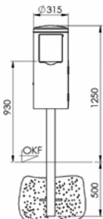
7077-00 Frontansicht zum Einbetonieren
